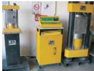
Ecrasement des éprouvettes
