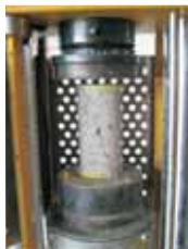
Ecrasement des éprouvettes
